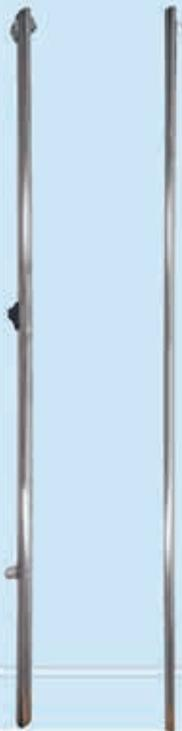
Οι κολώνες ακύρωσης εκκίνησης είναι κολώνες στήριξης ύψους 1,80m και Φ43 διαμέτρου. Κατασκευασμένες από ανοξείδωτο ατσάλι AISI-316 Η κολώνα PPP-180 φέρει ειδική τροχαλία η οποία οδηγεί το χαλαρωμένο σχοινί κατά την πτώση του στην επιφάνεια του νερού. Η κολώνα PPB-180 διαθέτει ένα υποστήριγμα για την σύσφιξη του σχοινιού. Οι κολώνες διαθέτουν σχοινί τάχιστης ελευθέρωσης μήκους 12,5 ή 21μ.
