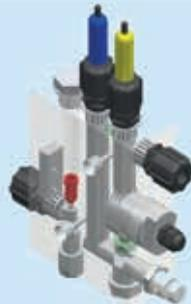
Αμπερομετρικό δοχείο με ηλεκτρόδια από πλατίνα και χαλκό, για την μέτρηση υπολειμματικού χλωρίου. Προεγκατεστημένοι καθετήρες σε ειδική βάση και αισθητήρα ροής και θερμοκρασίας. Έυρος μέτρησης 0,05 έως 5,00 ppm. Αυτοκαθαριζόμενο με υαλοσφαιρίδια. Ροή 40 λιτ / ω. Μέγιστη πίεση 3 bar. Σύνδεση παροχής 4X6 ή 8X12.
