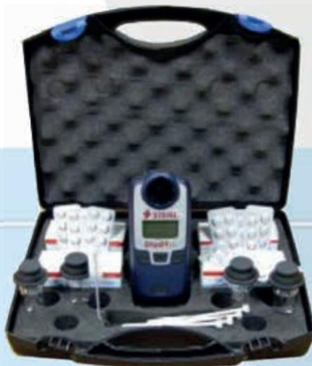
Επαγγελματικό σετ με φωτόμετρο για καλιμπράρισμα και έλεγχο των οργάνων μέτρησης. Μνήμη των δέκα τελευταίων μετρήσεων.
